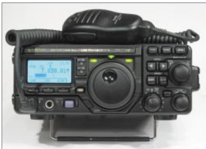
Frontansicht des FT-897, der Powervariante des QRP-Transceivers FT-817 mit sehr ähnlicher Konzeption.
