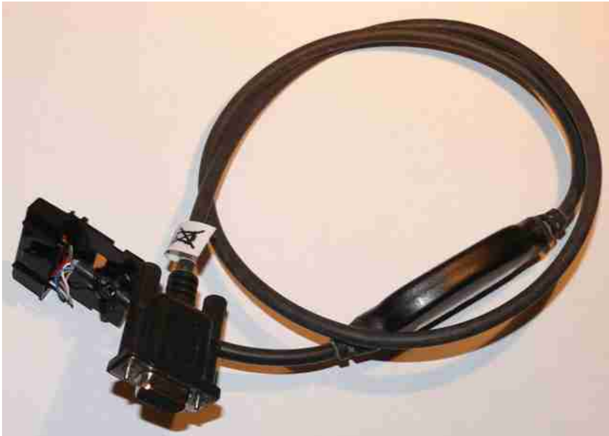
Aktives Datenkabel MTM800 FuG/MTM5400 vor der Erweiterung der Audioleitungen
