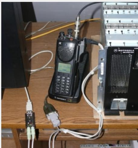
Anschluss eines XTS3000 an SvxLink (DB0WSF-R)
